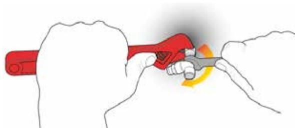
**Wichtig!** Halten Sie das Kupplungsstück mit einem Schraubenschlüssel fest, damit es sich nicht dreht, während Sie die obere T-Kupplung montieren.
