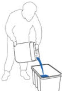
3. Das Flockungspulver in das Wasser geben und umrühren. Befolgen Sie die Anweisungen des Herstellers des Pulvers. Wenn die Farbstoffe auf den Boden des Behälters gesunken sind und das Wasser klar ist, ist der Trennvorgang abgeschlossen.
