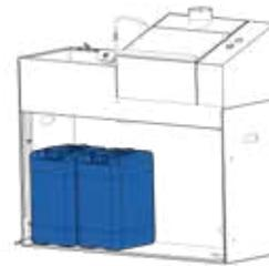
Das Fass auf der linken Seite wird das saubere Wasser enthalten. Schließen Sie den Adapterstecker mit dem Einzelschlauch daran an.
