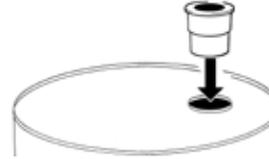
**Achtung!** Vergewissern Sie sich, dass alle Schläuche ordnungsgemäß bis zum Boden des Fasses geführt werden und dass die Öffnung durch den konischen Stopfen gut abgedichtet ist.
