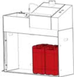
Das Fass auf der linken Seite enthält das saubere Lösungsmittel. Schließen Sie den Adapterstecker mit dem Einzelschlauch daran an.
