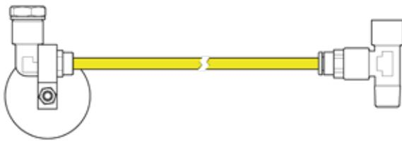
La manguera de aire se conecta a la entrada de aire de la pistola pulverizadora y se utiliza para secar el paso de aire después del procedimiento de limpieza externa.
