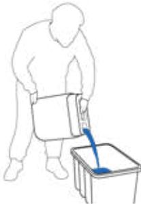
3. Añadir el polvo de floculación al agua y remover. Siga las instrucciones del fabricante del polvo. Cuando los restos de pintura hayan caído al fondo de la caja y el agua esté clara, el proceso de separación habrá terminado.
