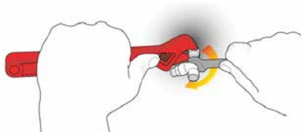
**¡Importante!** Utilice una llave inglesa para sujetar el racor de acoplamiento y evitar que gire mientras monta el acoplamiento en T superior.
