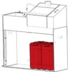
El tambor de la izquierda contendrá el disolvente limpio. Conecte a él el enchufe adaptador con la manguera única.
