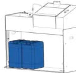
El bidón de la izquierda contendrá el agua limpia. Conecte a él el enchufe adaptador con la manguera única.
